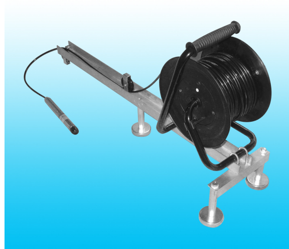
Figure 6 : Le système potence / touret et la sonde de pression
